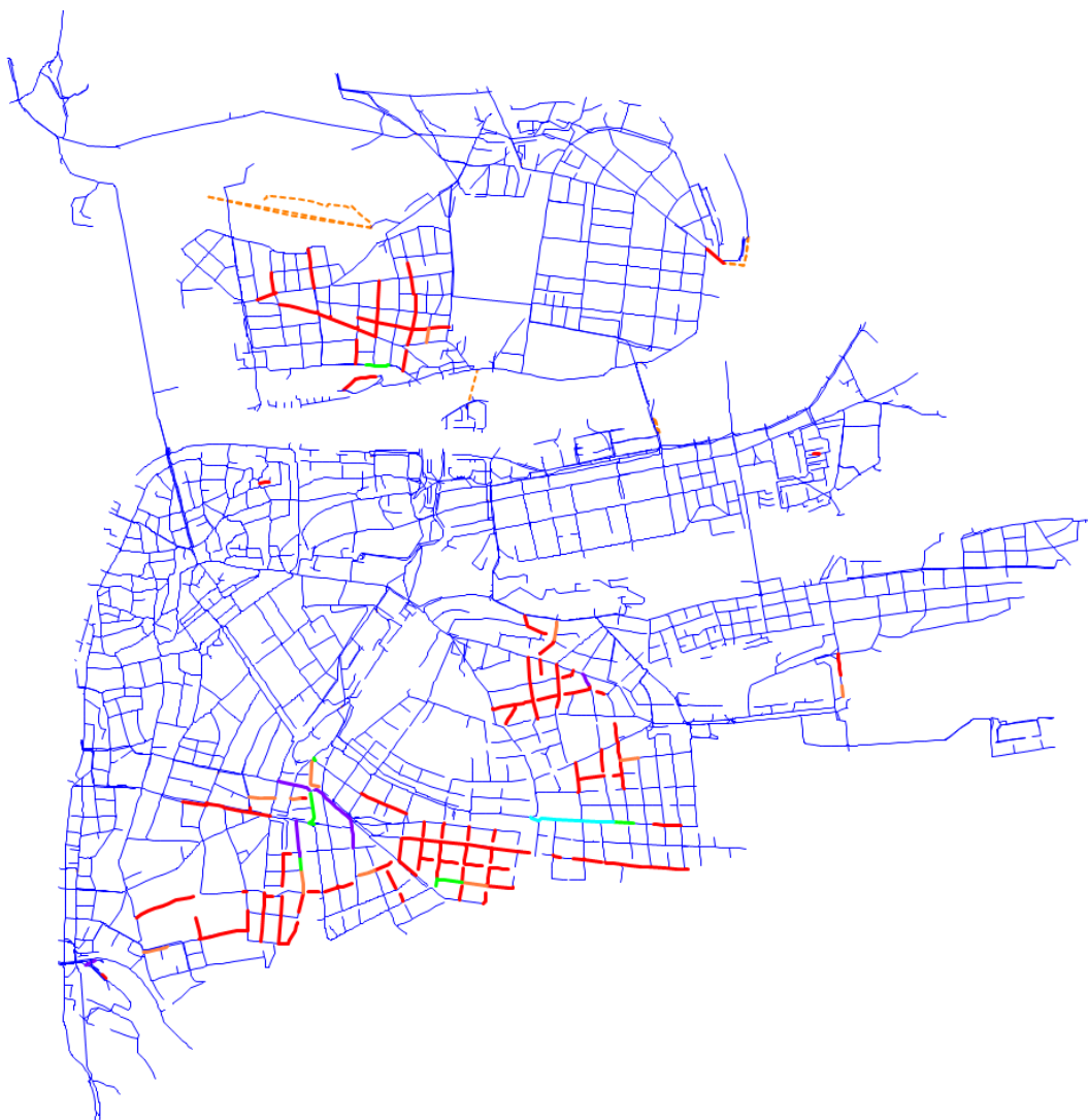
Obrázek 2.5 Úseky, navržené v databázi NZI na změnu profilu, zapracované do výhledového stavu
